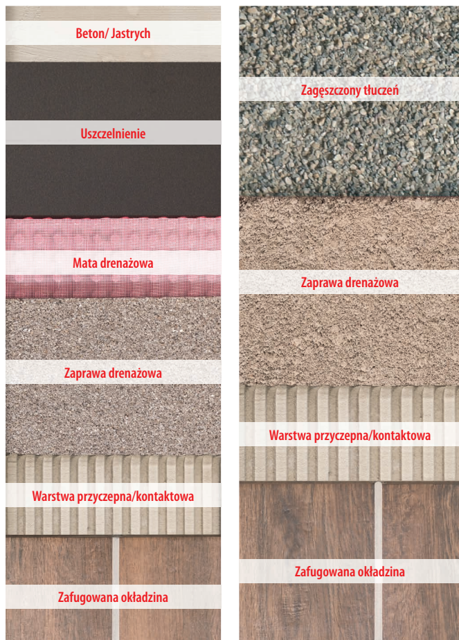
Uszczelnienie Sopro TDS 823 Mata drenażowa Sopro DRM 653 Zaprawa drenażowa Sopro DM 610 Zaprawa klejowa Sopro MEG 665 Fuga drenażowa Solitär® F20
